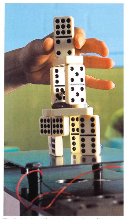
Bild 1. Mit Adaptronik lassen sich Maschinenbau-Konstruktionen «aufrüsten». Piezoelektronische Elemente wirken dabei als Sensoren und Aktoren. So kann man z. B. ein fragiles Gebilde aus Dominobausteinen auf dem Rütteltisch im Gleichgewicht halten. *FhG LBF*
