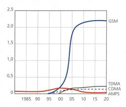
Bild 4. Prognosen über die Entwicklung der Mobilfunksysteme weltweit: Amerika hat sich für TDMA entschieden, wird damit aber weltweit unbedeutende Marktanteile halten (GSM: Global System for Mobile Communcations, TDMA: Time Division Multiple Access, CDMA: Code Division Multiple Access, AMPS: Advanced Mobile Phone System). *Quelle: MIT Sloan School*
