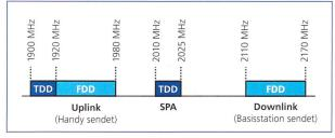
Bild 4. UMTS-Frequenzspektrum (Quelle: BAKOM).
