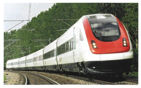
Bild 8. IC-Triebzug mit Neigetechnik (ICN).
