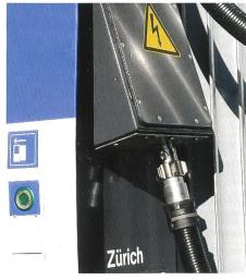
Bild 9. Verbinder zwischen zwei ICC-Wagen (ein Repeater versorgt die Antennen in mehreren ICN-Wagen).
