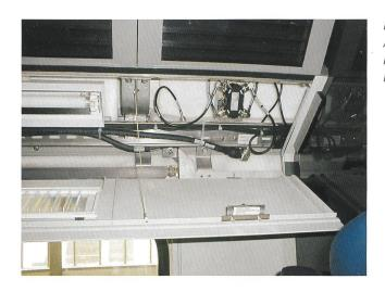
Bild 7. Antennenkoppler im IC 2000.
