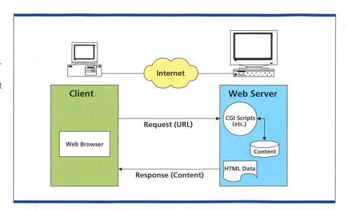
Bild 1. WWW-Funktionsmodell (WWW: World Wide Web, HTML: Hyper Text Markup Language, CGI: Common Gateway Interface, URL: Uniform Resource Locator).
