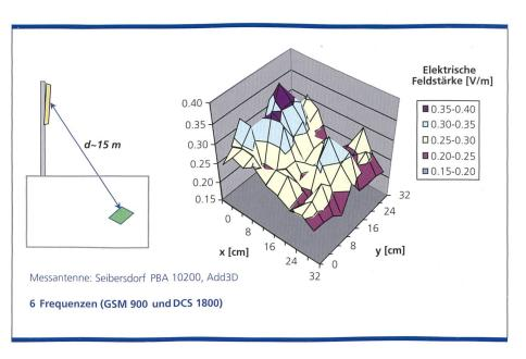
Bild 1. Feldstärkeverteilung in einer Ebene, gemessen bei einer GSM-Basisstation.
