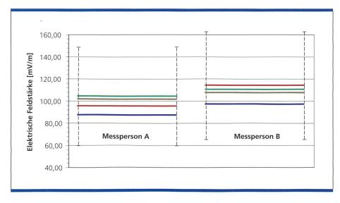
Bild 6. Messresultate Schwenkmethode (rot: Drive-Tester A, P-CPICH hochgerechnet, grün: Hybrid-Versorgungsmesssystem R, P-CPICH hochgerechnet, blau: Frequenzbereich Option Kanalleistungsmessung, braun: Frequenzbereich Bandbreite 100 kHz, RMS, korrigiert, Messunsicherheit ±42,8%). Linke Seite: Messperson A, rechte Seite: Messperson B.
