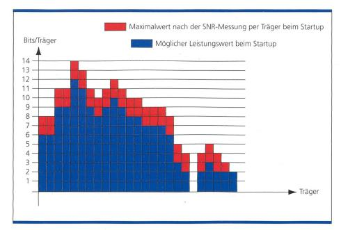
Bild 5. Bits pro Carrier.
