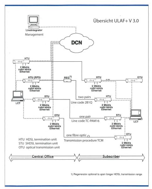
Bild 10. SHDSL-System von Siemens.
