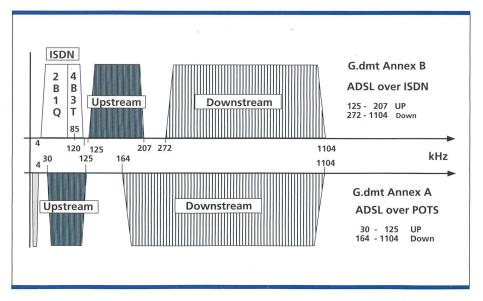
Bild 4. Frequenzspektrum von ADSL over POTS und ADSL over ISDN (POTS = Plain old Telephone Service: herkömmliches analoges Telefonnetz).
