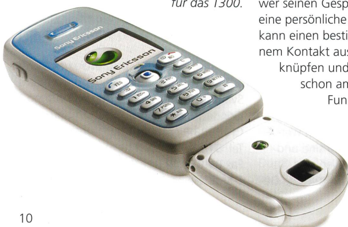
Bild 2. Sony Ericsson CommuniCam MCA-25 als digitale Ansteckkamera für das T300.
