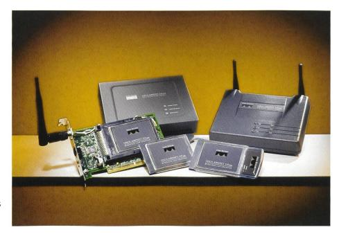
Bild 1. Gerätefamilie Cisco Aeronet 350 zur Realisierung von WLANs. Hinten im Metallgehäuse: Wireless Bridge 352 für Site-to-Site-Verbindungen (AIR-BR350-E-K9). Hinten mit zwei Antennen: Wireless AccessPoint 352 (AIR-AP352E2C). Vorne links: PCI-Karte für Desktop-PC (AIR-PCI352). Vorne Mitte: LMC-Karte für Geräte mit PCM-CIA-Slot, jedoch externer Antenne (AIR-LMC352). Vorne rechts: PCM-Karte für Laptops (AIR-PCM352). Alle Geräte verwenden einen Schlüssel mit 128 Bit.
