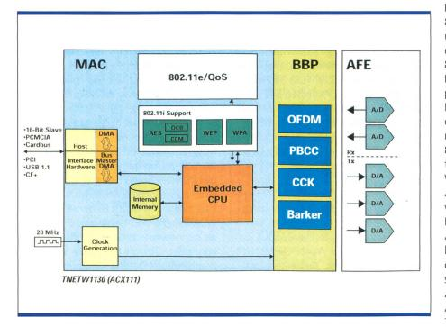
Bild 3. Hardware-Architektur des WLAN-Chips TNETW1130 von Texas Instruments.
