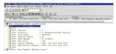
Bild 1. So sieht ein IPv6 Header in einem Trace File aus. Diese Struktur ist in RFC 2460 definiert. Im ersten Feld «Version» sieht man die 6 für IPv6. Weiter unten sieht man das Adressformat einer IPv6-Adresse (im Feld: Source und Destination Address).
