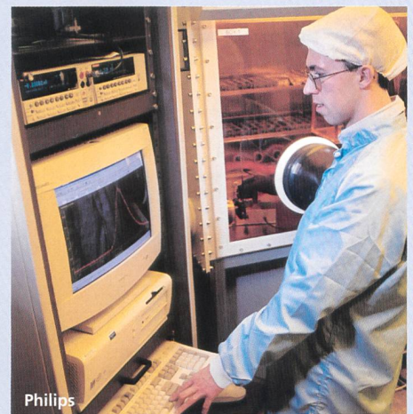
Das Bild zeigt einen Forscher beim Testen der optischen Eigenschaften des zwei-farbigen EL-Bausteins.
