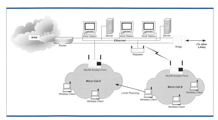
Bild 6. Beispiel für ein Ethernet-LAN, erweitert um zwei WLAN-Segmente.
