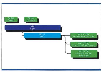
Bild 5. IEEE-802.11-Standards der Datenverbindungsschicht (OSI Layer 2).
