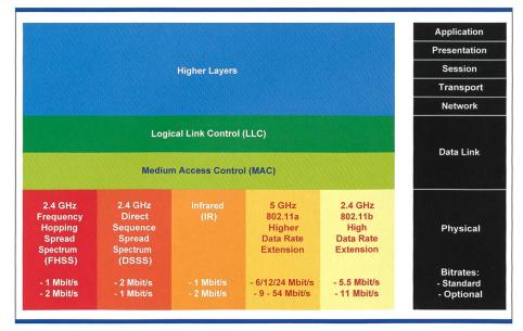
Bild 3. IEEE-802.11-Standards in Relation zu den OSI-Schichten.
