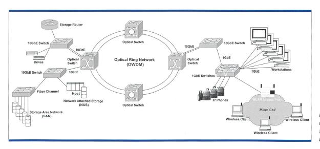
Bild 2. Anwendungsbeispiel für ein 10-Gigabit-Ethernet.
