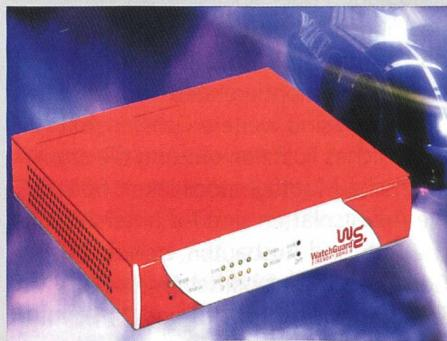
Ob DSL, Kabelmodem oder ISDN, die kompakte Firebox SOHO 6 von Watchguard ermöglicht Benutzern im KMU- und Heim-Office-Bereich hochsichere LAN- und Internet-Verbindungen. Die mit vier 10/100-Mbit-LAN-Ports versehene Firewall, die sich über jeden Web-Browser konfigurieren lässt, beinhaltet Dynamic NAT, Dynamic IP und einen DHCP-Server, der die IP-Adressen automatisch verteilt und so bis zu 10 bzw. 25 gleichzeitige Anwender (Upgrade-Op-
