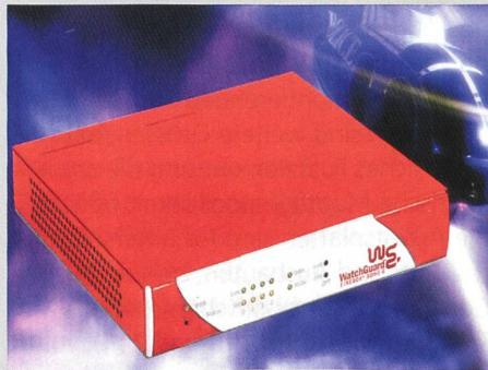
Ob DSL, Kabelmodem oder ISDN, die kompakte Firebox SOHO 6 von Watchguard ermöglicht Benutzern im KMU- und Heim-Office-Bereich hochsichere LAN- und Internet-Verbindungen. Die mit vier 10/100-Mbit-LAN-Ports versehene Firewall, die sich über jeden Web-Browser konfigurieren lässt, beinhaltet Dynamic NAT, Dynamic IP und einen DHCP-Server, der die IP-Adressen automatisch verteilt und so bis zu 10 bzw. 25 gleichzeitige Anwender (Upgrade-Op-
