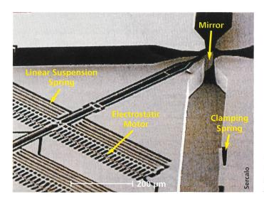
Bild 5. Linear beweglicher Spiegel an elektrostatischem Motor.
