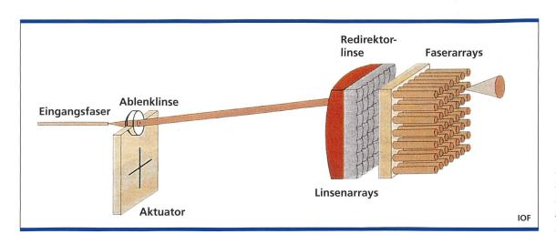
Bild 1. Optischer Schalter 1 × N mit mechanisch verschiebbarer Mikrolinse.
