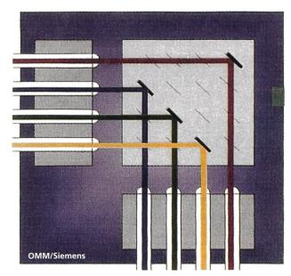
Bild 2. Matrix 4 × 4 mit in den Lichtstrahl herauszuklappenden Spiegeln.
