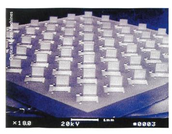
Bild 3. Anordnung von Spiegeln, die parallel zur Chipfläche in den Strahlweg hochspringen können.
