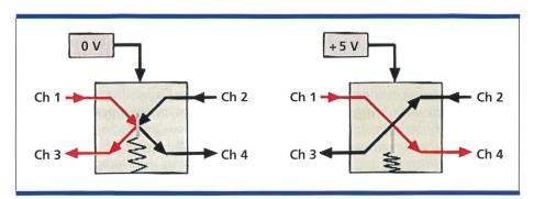
Bild 6. Funktion des optischen Schalters von Sercalo.
