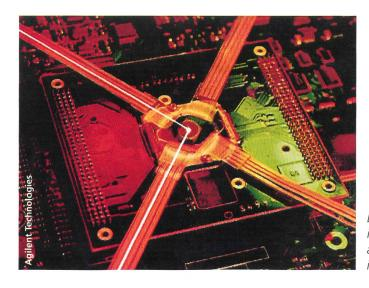
Bild 10. Gasblasen in einer Flüssigkeit als Schaltelemente in einer Matrix.
