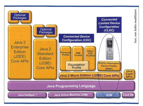
Bild 1. Drei verschiedene Java-Ausgaben, zugeschnitten auf den Endgerätetyp und die darauf laufende Anwendung.
