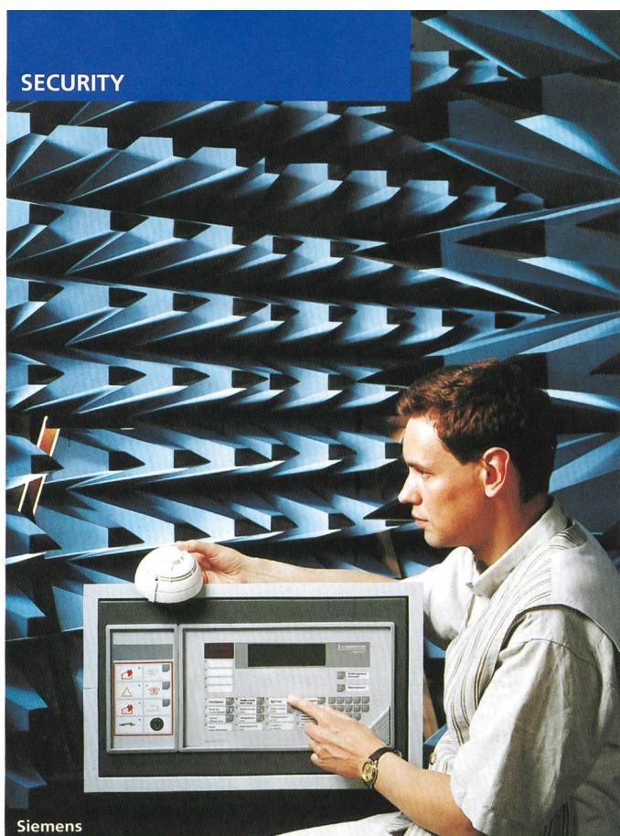
Ein Sicherheitssystem muss einwandfrei funktionieren und wird gründlich getestet; hier in Bezug auf die elektromagnetische Verträglichkeit.
