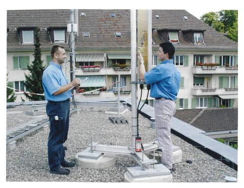
Bild 2. Distanzen und Antennenwinkel werden exakt ausgemessen, Gebäudematerialien ermittelt und Dachfenster, Oberlichter sowie zugängliche Orte, OMEN und OKA fotografiert. Es entsteht ein umfassendes NIS-Aufnahmedossier, das für die anschliessende NIS-Berechnung unverzichtbar ist.
