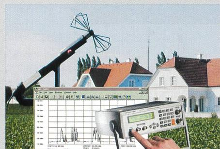
EmiField ermöglicht NISV-Messungen relativ einfach und mit der geforderten Messgenauigkeit durchzuführen. Die Software erlaubt nach allen von der NISV vorgeschlagenen Messmethoden zu messen. Es sind aber nicht nur Messungen von GSM-Basis-Stationen möglich, sondern alle erforderlichen Messungen von 10 MHz bis 2,6 GHz. Das System umfasst den Spektrumanalyser, die Antenne, die Software und eine komplett Kalibration. Nebst der üblichen Übersichtsmessung beinhaltet die Software auch eine gleich-
