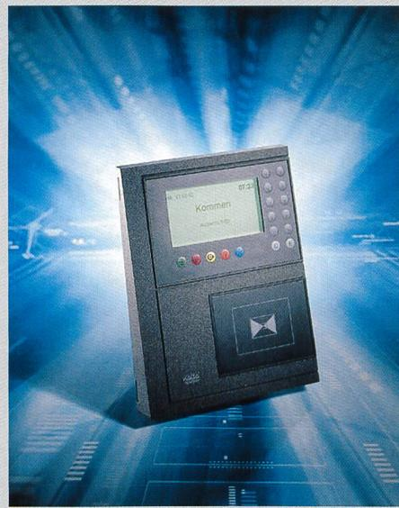
Das Terminal Bedanet 93 60 ist in Java programmiert und besitzt eine leistungsfähige CPU. Dadurch kann das Terminal mit einem grossen Datenspeicher ausgerüstet werden, der bei mehr als 10 000 Stammsätzen mehr als 50 000 Buchungen pro Tag verwalten kann. Neben den Standardfunktionen sind auch numerische Eingaben wie PIN-Code an einer Zehntastatur möglich. Insgesamt ste-
