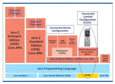
Bild 1. Drei verschiedene Java-Ausgaben – zugeschnitten auf den Endgerätetyp und die darauf laufende Anwendung (Quelle: Sun/modifiziert von Rüdiger Sellin).
