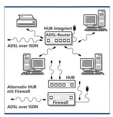
Bild 6. ADSL im Kleinbetrieb. Anzahl Endgeräte «unbeschränkt».
