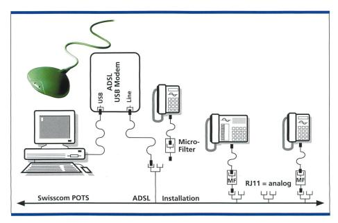
Bild 7. ADSL über POTS mit ADSL-Modem USB.
