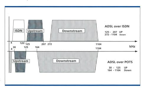
Bild 3. Frequenzspektrum auf der Anschlussleitung ADSL.
