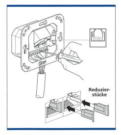
Bild 9. RJ-45-Dose mit Reduktionsmöglichkeiten auf RJ 11.
