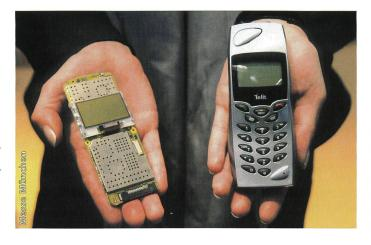
Bild 1. Ein Handy wartet auf seine Bauelemente: Ein paar hundert elektronische Bauteile bestimmen heute das Innenleben eines Mobilfunkgeräts.
