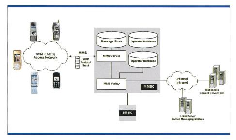
Bild 8. Einbindung eines MMS-Centers in ein bestehendes GSM-Mobilfunknetz. (MMSC: Multimedia Messaging Center; SMSC: Short Message Service Center; WAP: Wireless Application Protocol; GSM: Global System For Mobile Communications.)
