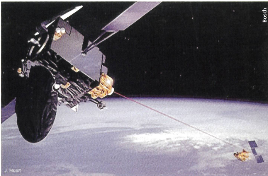
Bild 1. Schematische Darstellung der optischen SILEX-Versuchsstrecke zwischen zwei in unterschiedlich hohem Orbit umlaufenden Satelliten.
