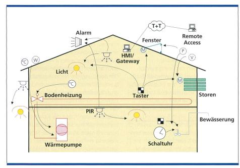
Bild 3. Digital Home in Grono. Im Bild ist nur ein Teil der realisierten Funktionen dargestellt.
