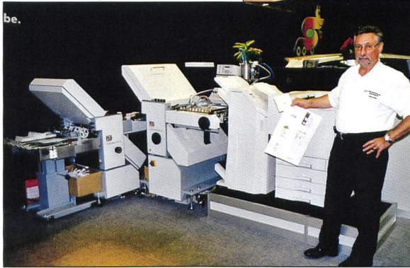
Bild 9. Mit dieser Maschine (Kostenpunkt rund Fr. 110 000.–) entsteht in wenigen Augenblicken aus einem farbigen A3-Blatt ein gefalztes und an den richtigen Stellen exakt geklebtes CD-Cover.
