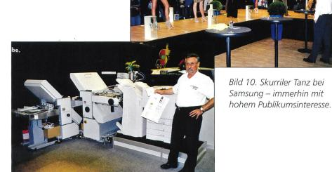
Bild 9. Mit dieser Maschine (Kostenpunkt rund Fr. 110000.–) entsteht in wenigen Augenblicken aus einem farbigen A3-Blatt ein gefalztes und an den richtigen Stellen exakt geklebtes CD-Cover.
