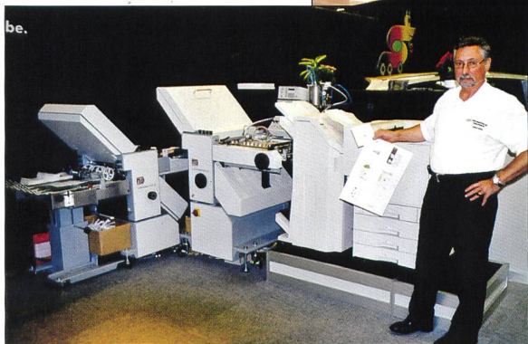
Bild 9. Mit dieser Maschine (Kostenpunkt rund Fr. 110 000.–) entsteht in wenigen Augenblicken aus einem farbigen A3-Blatt ein gefalztes und an den richtigen Stellen exakt geklebtes CD-Cover.
