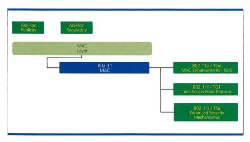
Bild 3. IEEE-802.11-Standards der Datenverbindungsschicht (OSI Layer 2).
