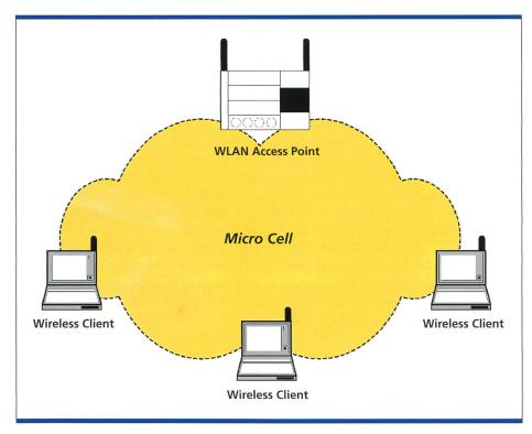
Bild 4. WLAN-Interface zwischen Zugangspunkt (Access Point) und drahtlosem Endgerät.
