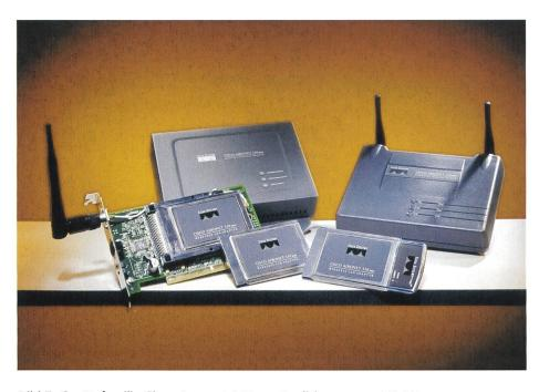
Bild 7. Gerätefamilie Cisco Aeronet 350 zur Realisierung von WLANs. Hinten im Metallgehäuse: Wireless Bridge 352 für Site-to-Site-Verbindungen (AIR-BR350-E-K9). Hinten mit zwei Antennen: Wireless Access Point 352 (AIR-AP352E2C). Vorne links: PCI-Karte für Desktop-PC (AIR-PCI352). Vorne Mitte: LMC-Karte für Geräte mit PCMCIA-Slot, jedoch externer Antenne (AIR-LMC352). Vorne rechts: PCM-Karte für Laptops (AIR-PCM352). Anmerkung von Cisco: Alle Geräte verwenden einen Schlüssel mit 128 Bit.
