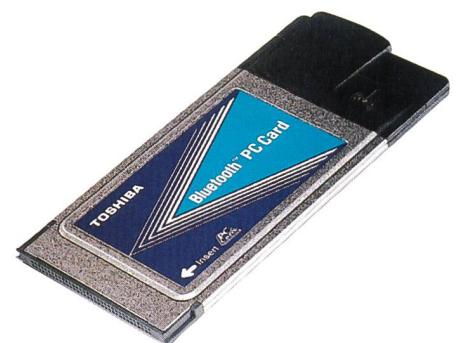
Bild 12. Bluetooth-fähige PCMCIA-Karte von Toshiba zur Erweiterung von PC und Beamer.
