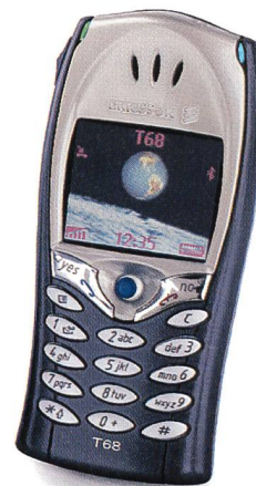
Bild 2. Ericsson-Triple-Band-GSM-Handy T68i mit Bluetooth, GPRS, Wireless Java und MMS.
