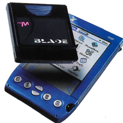
Bild 10. Red-M-Blade (Bluetooth-Karte) mit Handspring Visor.
