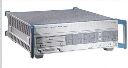
Mit dem R&S DVATM präsentiert Rohde & Schwarz das erste Messgerät weltweit, das MPEG2- und ATM-Datenströme senden, empfangen, analysieren und aufzeichnen kann. Der R&S DVATM wurde für Anwender konzipiert, die MPEG2-
