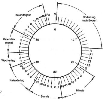
Bild 1. Protokoll des Präzisions-Zeitsignals, das vom Sender DCF77 verbreitet wird.
