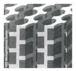
Bild 2. Dieser schematische Aufbau zeigt einen dreidimensionalen Bandgap-Kristall für eine Wellenlänge von 790 nm. Die hellgrauen Regionen entsprechen Silizium mit einem hohen Brechungsindex von 3,4 und die dunkelgrauen Regionen sind aus SiO2 mit einem niedrigen Brechungsindex von 1,4.
