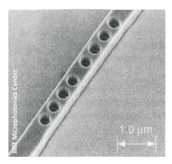
Bild 4. Photonischer Kristall eines Add/Drop-Filters. Dies stellt die erste funktionierende Demonstration von Sub-Mikrometerstrukturen für die optische Kommunikation dar. Die minimalen Abmessungen dieses Resonanz-Wellenleiters liegen bei 100 nm.
