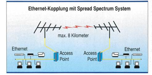
Bild 1. Typische Lösung für die Ethernet-Kopplung mittels Spread-Spectrum-Systemen (Funk-Bridges).
