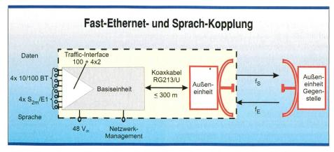
Bild 4. Eine gängige Sprach-Datenkopplung mit integrierten Switches für 10/100-BaseT-Netze und maximal 120 Sprachkanäle sowie einer Reichweite von bis zu 20 km.
