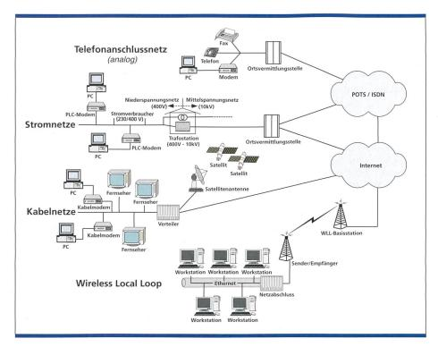
Bild 4. Powerline Communications (PLC).
