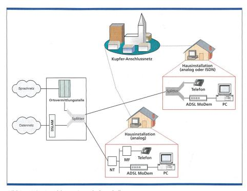
Bild 2. ADSL-Anschluss mit und ohne Splitter.
