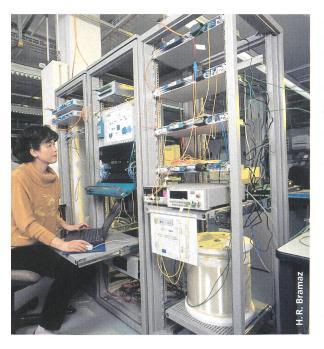
Bild 1. Testaufbau eines transparenten, optischen Ringnetzwerks neuster Technologie im Broadband Lab (im Rahmen des Explorationsprogramms Broadband Communication Opportunities).
