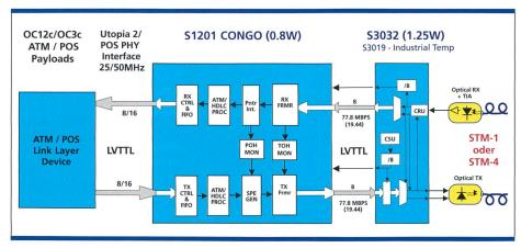
Bild 3. Congo: STM-1 und STM-4 mit der gleichen Hardware.
