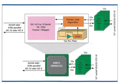
Bild 1. Orinoco kombiniert einen STM-1/4-Mapper und zwölf PLL-Filter mit UCXO in einem Single Chip.
