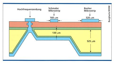
Bild 10. Mit steigenden Frequenzen muss man die parasitären Kopplungen in den Griff bekommen, die beispielsweise für Nebensprechen «zuständig» sind.
