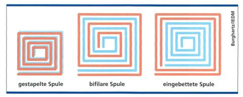
Bild 9. Die Integration passiver Bauelemente in Siliziumchips muss vorangetrieben werden. Über 200 passive Bauelemente befinden sich heute noch in einem Mobilfunk-Handgerät. Insbesondere die Integration von Induktivitäten ist schwierig.
