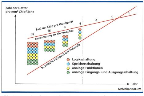
Bild 3. Kostensenkung hat den Mobilfunkgeräten breite Abnehmerschichten bis hin zu Kindern erschlossen. Der Weg zum 1-Chip-Handgerät ist vorgezeichnet.
