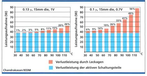
Bild 6. Mit schrumpfenden Strukturen auf dem Chip steigt die Verlustenergie durch Leckagen auf dem Chip. Je höher die Betriebstemperatur des Chip, desto stärker wirkt sich dies aus.
