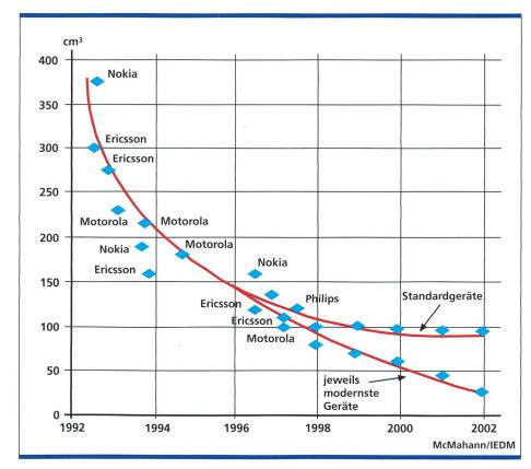
Bild 2. Klein ist schön – das gilt bei Mobilfunkgeräten schon seit den 90er-Jahren. Innerhalb einer Dekade ist das Volumen der Handgeräte auf etwa ein Zehntel zurückgegangen.
