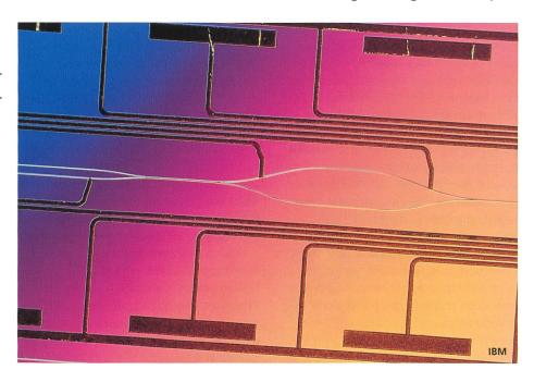
Bild 1. Ausschnitt aus einer planaren optischen Wellenleiter-Komponente, um einzelne Wellenlängen hinzuzufügen und herauszufiltern. Die dunkleren Strukturen sind Widerstandsstreifen aus Chrom zum Aufheizen der Wellenleiter.
