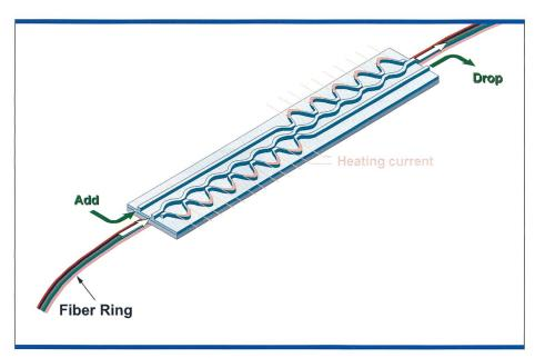
Bild 4. Add/Drop-Filter dienen dazu, einzelne Wellenlängen einem Lichtstrahl hinzuzufügen oder aus diesem herauszufiltern.
