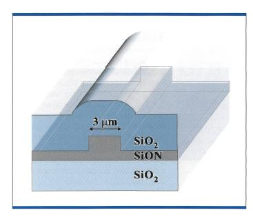
Bild 3. Die planaren optischen Wellenleiter aus dem IBM Forschungslabor bestehen aus 3 µm breiten optischen Kanälen aus Silizium-Oxinitrid (SiON) zwischen zwei Schichten aus Silizium-Dioxid (SiO<sub>2</sub>).
