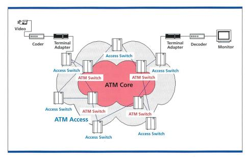
Bild 2. Einsatz von ATM als Übertragungstechnologie.
