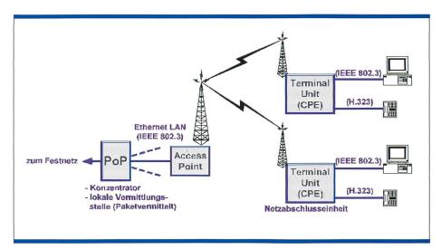
Bild 3. Prinzipdarstellung für die Funktionsweise eines Point of Presence (PoP) für Wireless Local Loop (WLL). Damit können Voice- und Internetzugangsdienste bei einer Geschwindigkeit von rund 1 bis 8 Mbit/s angeboten werden. Die lokalen Schnittstellen basieren häufig auf den Standards H.323 für Voice over IP und 802.3 für Ethernet.
