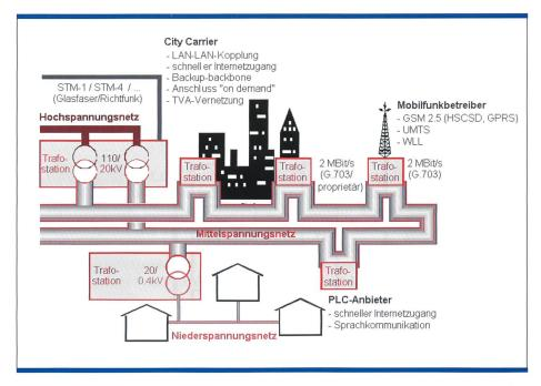
Bild 2. Viel versprechendes Angebot basierend auf Powerline Communications (PLC). Damit wird die normale Steckdose zur Kommunikationsverbindung für den Voice-und Internetzugang sowohl für den Privatkunden (unten) als auch für den Geschäftskunden in Grossstädten (oben). STM: Synchronous Transfer Mode, STM-1 mit 155 Mbit/s und STM-4 mit 622 Mbit/s; TVA: Teilnehmervermittlungsanlage.
