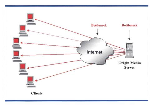
Bild 4. Data Streams gehen vom Media Server direkt ins Internet. Bandbreitenprobleme sind vorprogrammiert.
