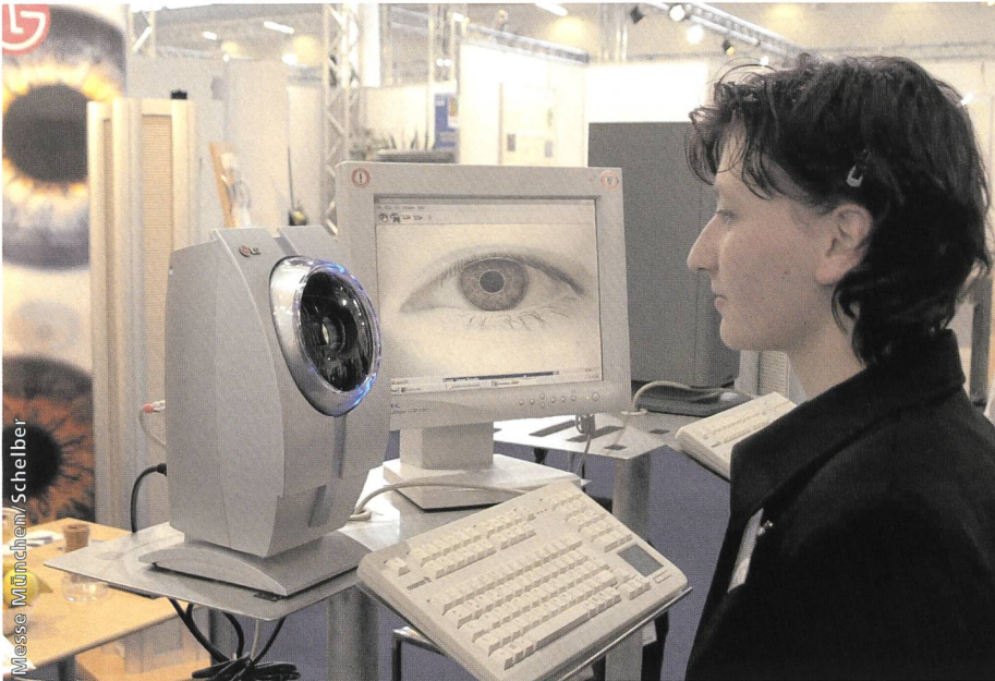
Bild 6. Eine Alternative zu Fingerabdruck ist die Iris-Erkennung. Sie ist noch sicherer, zumal sie keinen Kontakt zwischen Sensor und Auge erfordert.
