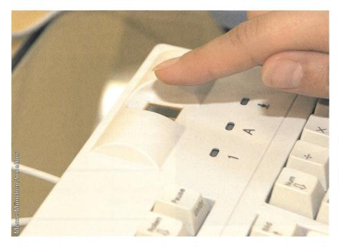
Bild 4. Wer den Zugang zu seinem PC mit mehr als nur einem Passwort schützen will, kann dafür erste Tastaturen erwerben, die einen Fingerabdruck als biometrischen Schlüssel verwenden.
