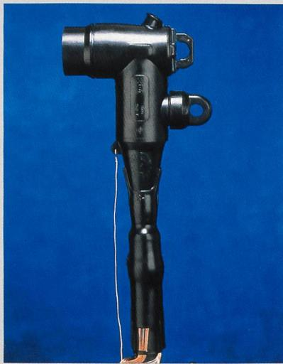
Die neuen Steckendverschlüsse für die Mittelspannung sind hochwertige, vorgefertigte Steckersysteme. Sie passen zu herkömmlichen Kunststoffkabeln bis 36 kV und werden zum Anschluss an Schaltanlagen, Transformatoren und Motoren eingesetzt. Berührungs-sicherheit und Zuverlässigkeit sind garantiert. Die halbleitende Außenbeschichtung ist geerdet und verhindert frei liegendes Spannungspoten-
