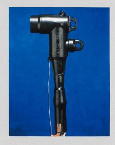
Die neuen Steckendverschlüsse für die Mittelspannung sind hochwertige, vorgefertigte Steckersysteme. Sie passen zu herkömmlichen Kunststoffkabeln bis 36 kV und werden zum Anschluss an Schaltanlagen, Transformatoren und Motoren eingesetzt. Berührungssicherheit und Zuverlässigkeit sind garantiert. Die halbleitende Aussenbeschichtung ist geerdet und verhindert frei liegendes Spannungspoten-
