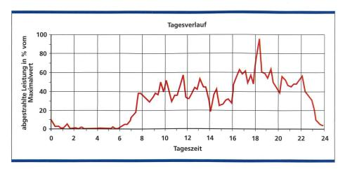
Bild 1. Typischer Tagesverlauf der Sendeleistung ohne BCCH. Die durchschnittliche Sendeleistung beträgt gemittelt 30%; zwischen 7.00 und 19.00 Uhr weniger als 50%. Die maximale Sendeleistung wird in der Regel nur während einer kurzen Zeit pro Tagerreicht.
