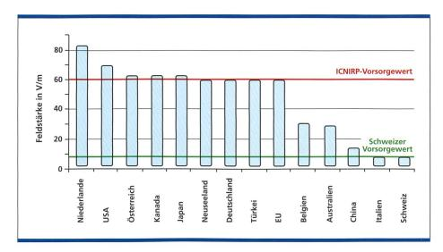
Bild 2. Mobilfunkgrenzwerte für 1800 MHz im internationalen Vergleich.
