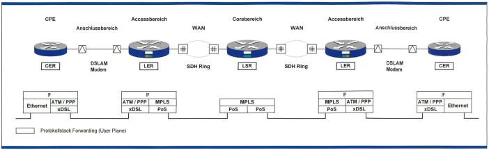
Bild 4. Protokoll-Stack der ATM-basierten Architektur.
