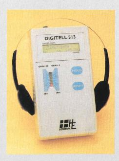
Polarität der Linie sowie «On/off-hook»-Staus werden angezeigt. Bis 32 Digits können gespeichert und 16 Digits gleichzeitig digital angezeigt werden. Das Bargraph-Display zeigt Sprache und Daten an im Bereich von 0 bis -30 dBm und mit eingeschaltetem Verstärker von -20 bis -50 dBm. In einem bestimmten Modus entdeckt das Gerät die Caller-ID (DTMF) auch on-hook. Signale oder Gespräche können ohne Störeinflüsse abgehört und überwacht werden.
