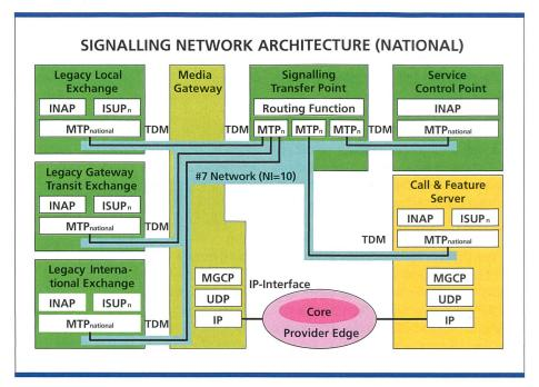
Bild 8. Signalling Network Architecture National.
