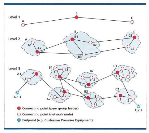
Bild 2. Hierarchische Peer Groups innerhalb eines P-NNI-Netzes.
