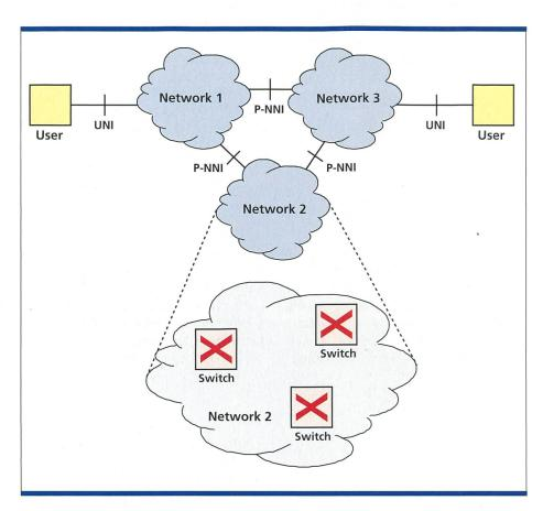
Bild 1. P-NNI-Netz (Beispiel). UNI: User Network Interface; P-NNI: Private Network Node Interface.
