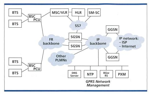
Bild 2. GPRS system architecture.
