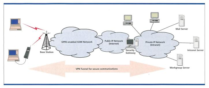
Bild 3. Sicherer Zugriff auf ein Internet via GPRS. GSM: Global System for Mobile Communications; GPRS: General Packet Radio Services; IP: Internet Protocol; VPN: Virtual Private Network.
