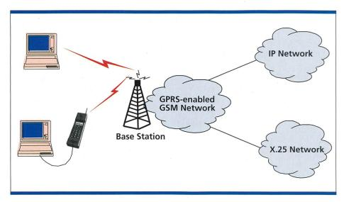
Bild 1. GPRS als Zugangsdienst zu paketvermittelten Datennetzen (z.B. IP, X.25). GSM: Global System for Mobile Communications; GPRS: General Packet Radio Services; IP: Internet Protocol; X.25: paketorientiertes Datenprotokoll (ITU-T-Empfehlung).
