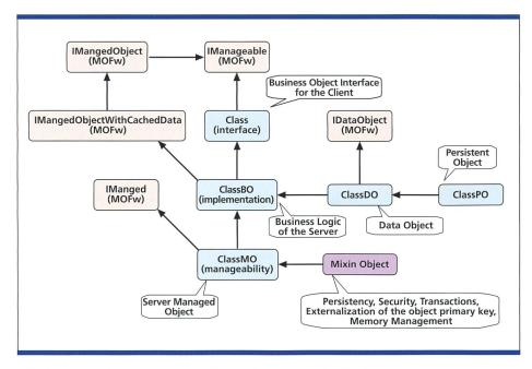
Bild 9. Ausschnitt aus Managed Object Framework (MOFw).
