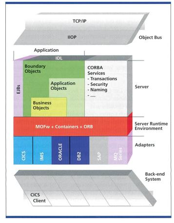
Bild 10. Architektur Component Broker.
